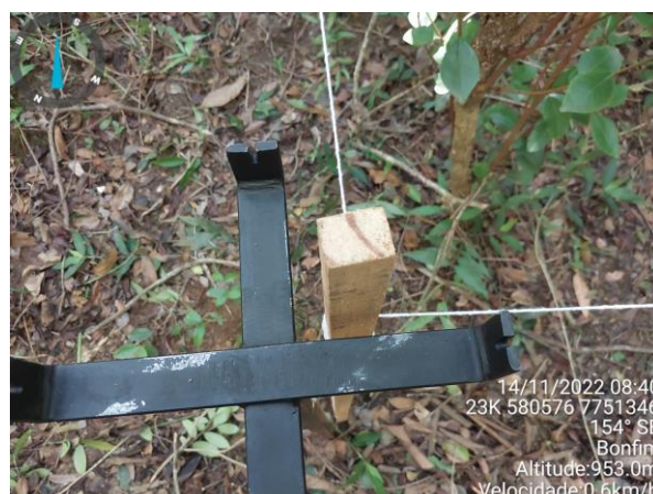
Figura 11.24 – Realização das visadas de ré e vante utilizando a mira em forma de cruzeta
