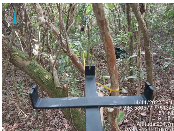
Figura 11.23 – Utilização da mira em forma de cruzeta para delineamento da parcela
